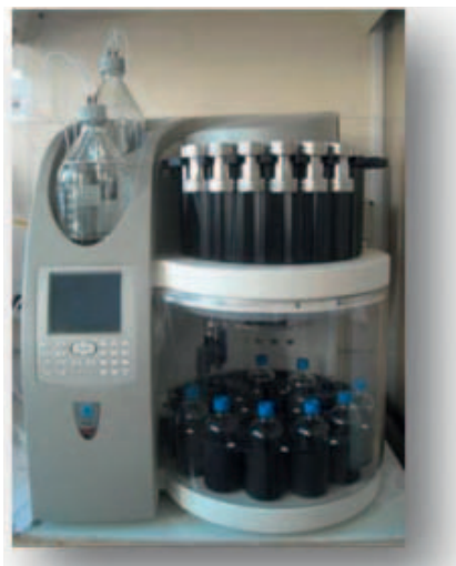
Système d'extraction automatique (sol pollué sédiment pour analyse PCB notamment)
